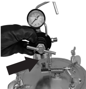
Fig. 3 – Montagem do conjunto do regulador
